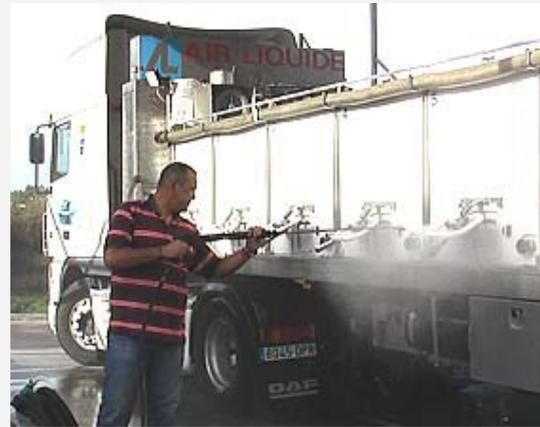
Desinfección exterior de plataformas. Centrales móviles de agua caliente a presión con dosificación de hipoclorito sódico
