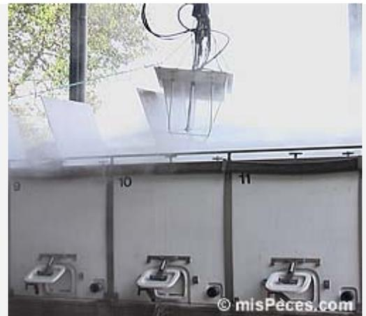
Desinfección exterior de plataformas. Centrales móviles de agua caliente a presión con dosificación de hipoclorito sódico
